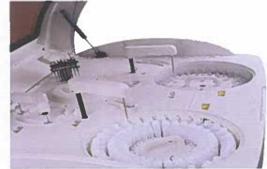
MINDRAY BS 380 GLICEMIA, AZOTEMIA, CREATININA, COLESTEROLO TOTALE, HDL, LDL TRIGLICERIDI, ACIDO URICO, LDH BILIRUBINA TOTALE e FRAZIONATA, AMILASI, FOSFATASI ALCALINA, LIPASI, ELETTROLITI, GAMMA GT, TRANSAMINASI GOT e GPT, CPK.
