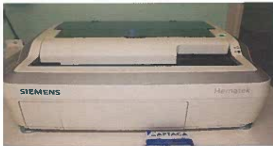
SIEMENS HEMATEK COLORATORE per EMATOLOGIA Utilizzato per la colorazione degli strisci di sangue periferico con metodica Giemsa - Wright per il controllo della formula leucocitaria al microscopio ottico.
